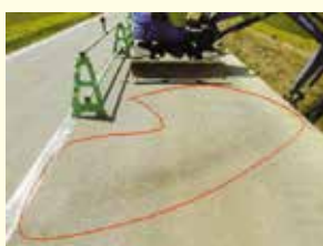
バックホーの作動油のホースが破裂して、舗装の上に漏れている。
