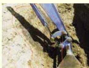
バックホーの作動油のホースが破裂して、内法面上に漏れた状況。
